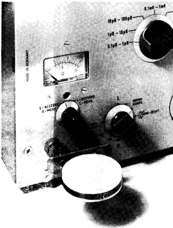
Vorbereitung zum Messen von Induktivitäten unter 100 nH. links ohne, rechts mit Meßobjekt
